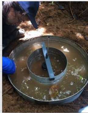
Prueba de infiltración de agua en el suelo
